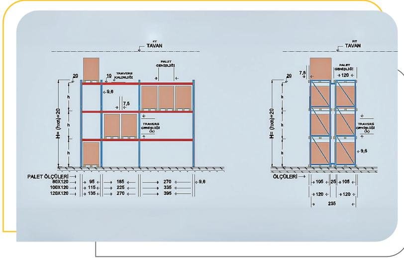
**Paletli Yükleme Rafları**, standart ve farklı ölçülerdeki paletlerin depolandığı en yaygın raf sistemidir. Kullanılacak istif aracının ve depolanacak paletlerin özelliklerine göre dizayn edilir. Ayak derinliği standart paletlere göre 105 cm'dir. Paletler, seri ve emniyetli şekilde yükleme ve boşaltma yapılması amacıyla her iki taraftan 7,5 cm traverslerden dışarı atar.
