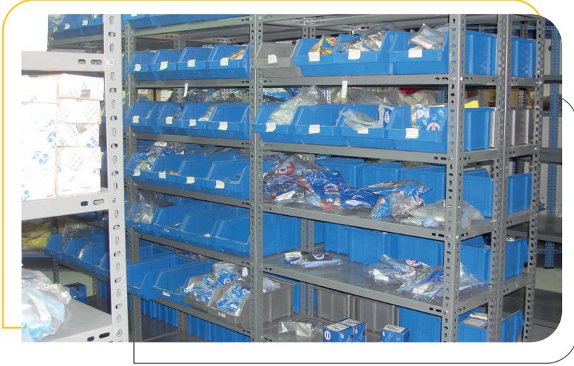
**Cıvatalı Depo Rafları**, Genellikle küçük ve hafif malzemelerin depolanmasında kullanılan raf sistemidir. Depolanacak malzemeye göre, istenilen ölçü ve kalınlıklarda yapılır. Oluşturulacak çelik raf ünitelerine ağır malzeme koyulması durumunda tablaların sac kalınlığı arttırılabildiği gibi altlarına takviye parçaları koyularak rafların deformasyonu önenebilir. Yanları ve arkaları kapatılabildiği gibi göz aralıkları seperatör ile bölünerek çok gözlü üniteler oluşturulabilir.
